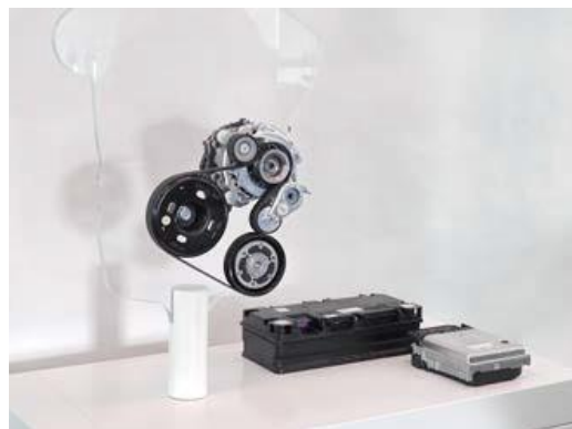
48Vベルト統合型スターター ジェネレーターと48VバッテリーおよびDC/DCコンバーター
