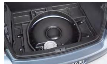
LPG または液化ガス タンク （ラゲージ ルーム フロア内）
