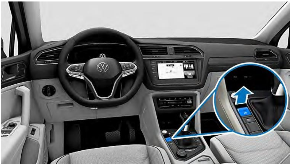
従来型のオートマチック ギヤボックス車：EPB をかける、またはパーキング ブレーキ レバーを引く
