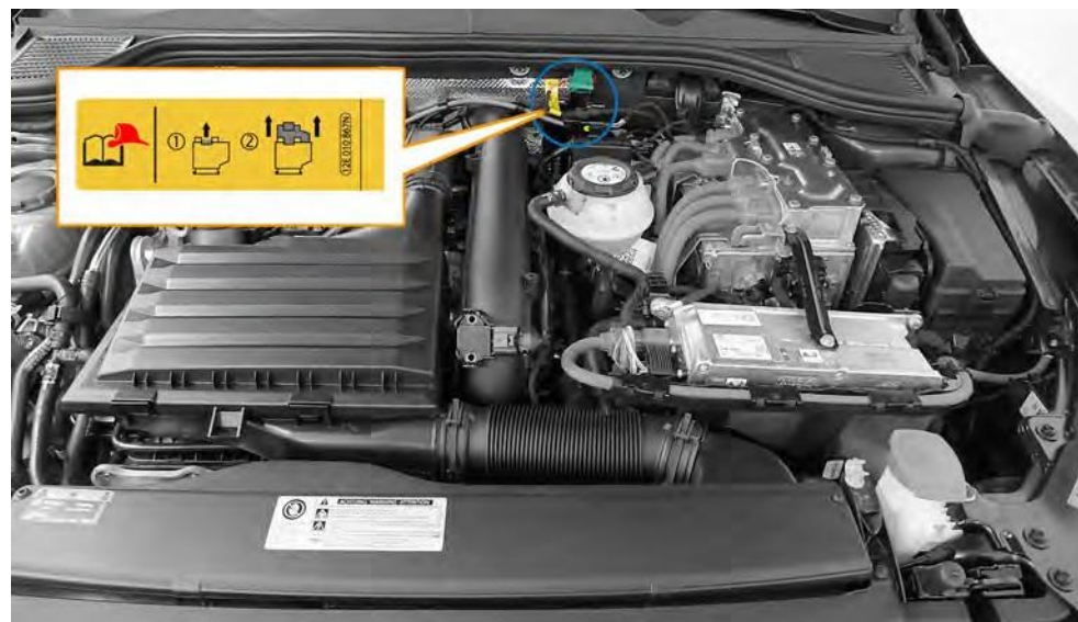
ハイブリッド車（例：Golf GTE（2020 年モデル以降））：遮断ポイント（車両フロントエンド部）（参照：新しい識別タグ（ID. 7 以降））
