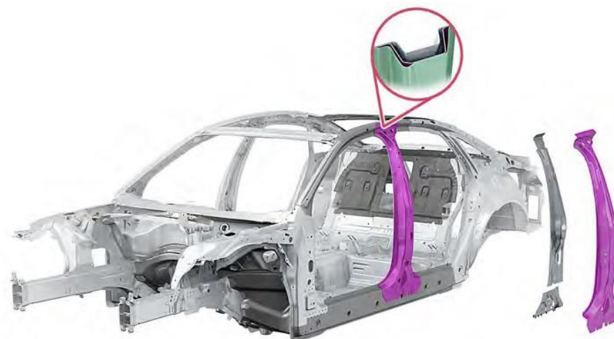
B ピラーのマルチ シェル構造
