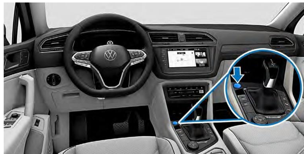
「START ENGINE STOP」ボタン（センター コンソール内）を装備した車両
