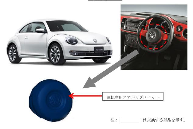
運転席用エアバッグのインフレータ(膨張装置)において、高い湿度の環境下で大きな温度変化を繰り返すと、ガス発生剤が劣化することがある。そのため、エアバッグ展開時にインフレータ容器が破損するおそれがある。
