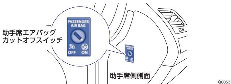
助手席側フロントエアバッグの作動を停止すると、センターコンソール上部の警告灯が切り替わります。
