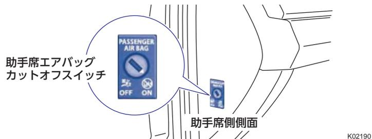
助手席側フロントエアバッグの作動を停止すると、センターコンソール上部の警告灯が点灯します。
