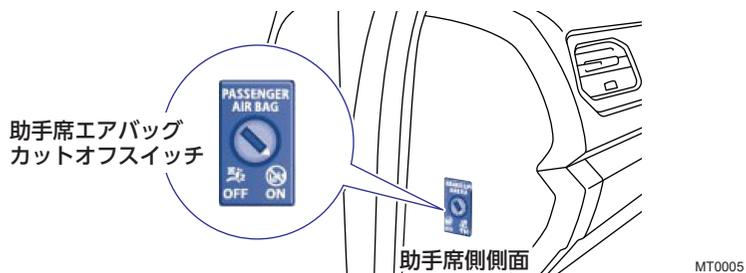
助手席側フロントエアバッグの作動を停止すると、ルーフコンソール部の警告灯が切り替わります。
