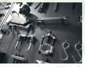
フォルクスワーゲン車だけの専用修理工具
